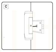
Realice la conexión eléctrica y coloque la luminaria sobre la
